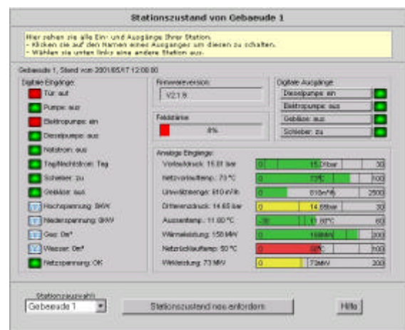
Abbildung 3 Darstellung einer physikalischen Stationsübersicht mit DxNET.
